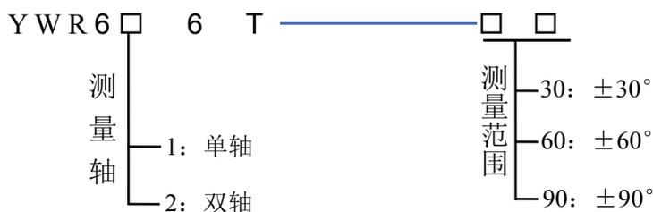
例如: YWR626T—30—(RS232): 双轴测量/±30°测量范围, LORA 通讯; 水平或竖直安装 二选一, 参照“产品尺寸与安装”示意图, 订购时备注。
